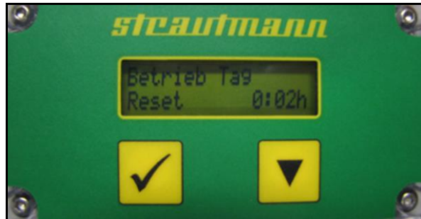
Fig. 81 „Betrieb Tag“ = Daily service hours „Reset“ = Reset
