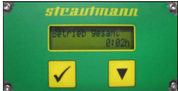
Fig. 80 „Betrieb gesamt“ = Total number of service hours
